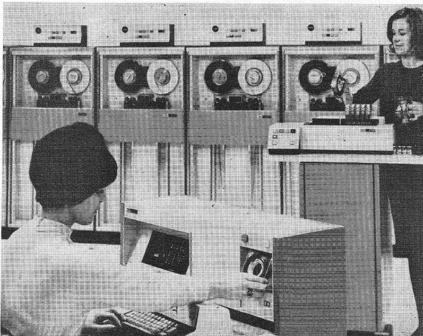
Met behulp van het toetsenbord van de IBM 050 magneetbandschrijver wordt informatie vastgelegd op magneetband, die door de IBM 2495 cassettebandlezer wordt gelezen.
